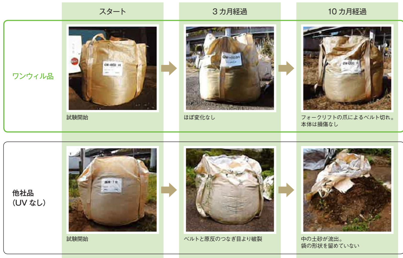
ワンウィルのフレコンバッグは全てUV 剤配合で長持ち
